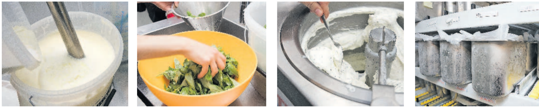
Kaltes Handwerk: Der Eisfond wird angesetzt, die Zutaten (hier Basilikum) zerkleinert, dann kommt alles in die Eismaschine, bis das fertige Produkt im Gefrierhaus steht.
